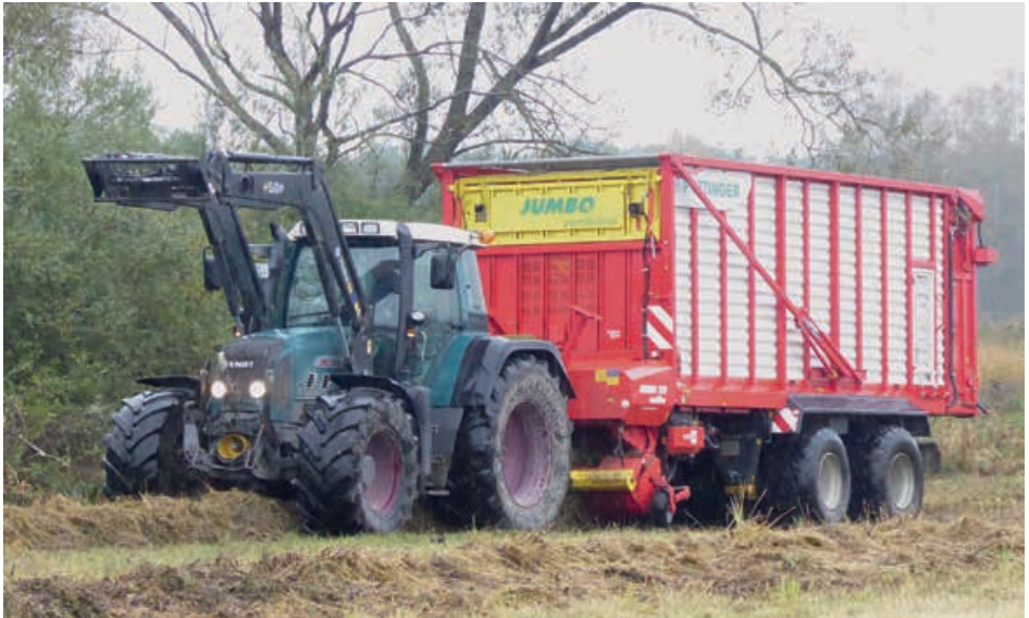
Maschinelle Streuwiesenpflege mit moderner Landschaftspflegetechnik: Ein Spezialladewagen mit acht Rädern auf zwei Achsen sorgt für bodenschonende Arbeit. Foto: Johannes Ruf
