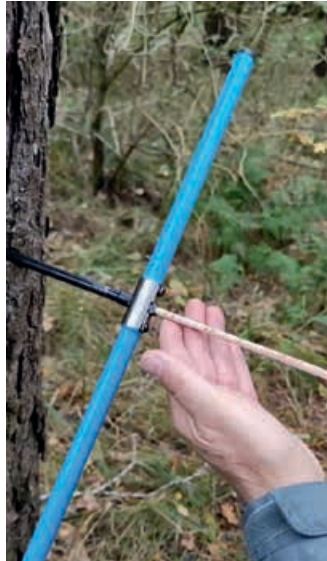
Dendrobohrer mit gewonnenem Dendro- bohrkern, deutlich sind die Jahresringe zu erkennen.
